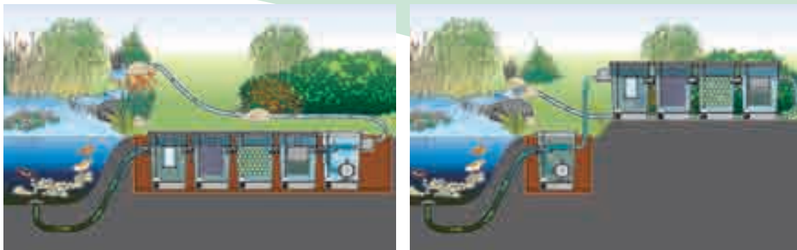
VÁLTOZÓAN ALKALMAZHATÓ a Proficlear modulszűrő rendszer. A különösen energiatakarékos gravitációs elven működik, vagy akár mint nyomás alatti rendszer.
