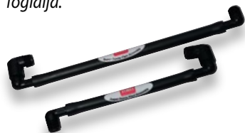
Super Funny Pipe rugalmas fejbekötő készletek 20 és 30 cm-es (8" és 12") hossz 1/2" és 3/4" csatlakozás
